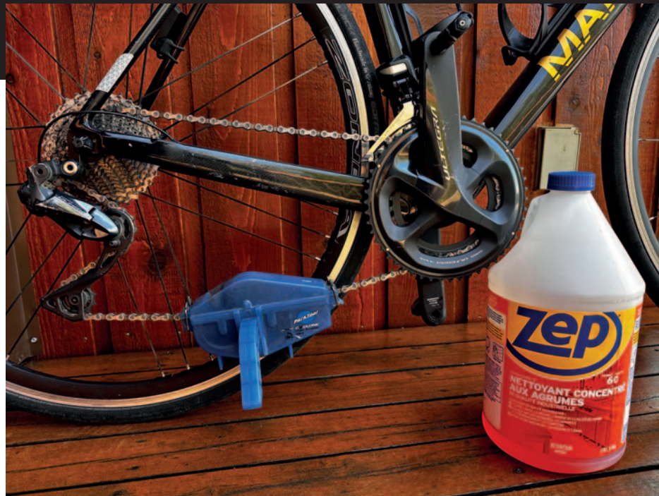
Un bain occasionnel de la chaîne dans le dégraissant lui fait le plus grand bien!
